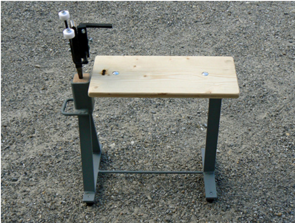
Dengelstock aus Flacheisen mit Dengelamboss und Führung, leicht zu transportieren und stabil
