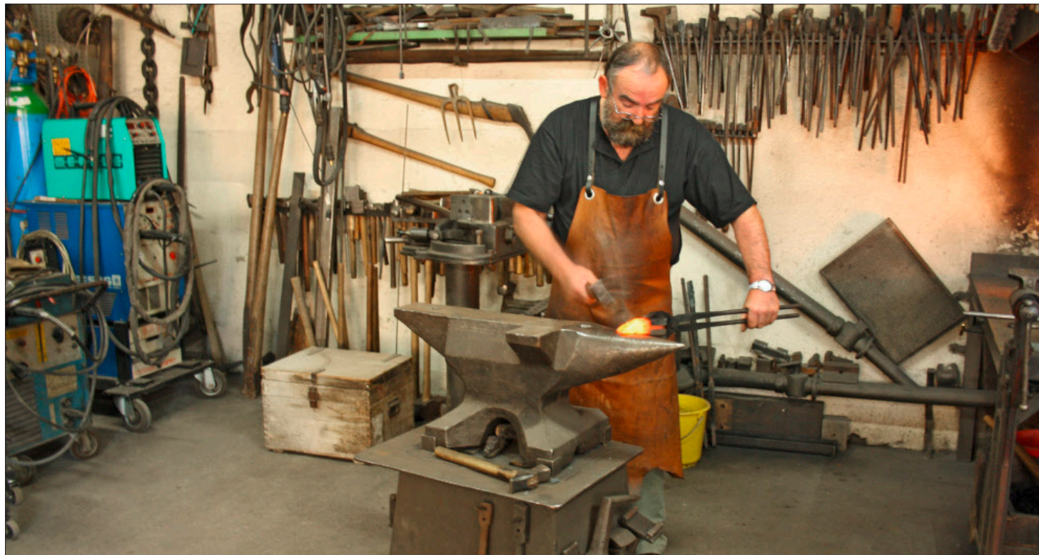
Heinz Stalder stellt in seiner Schmiede noch von Hand Dengel-Hämmer her. (Bilder: Jacqueline Graber)
